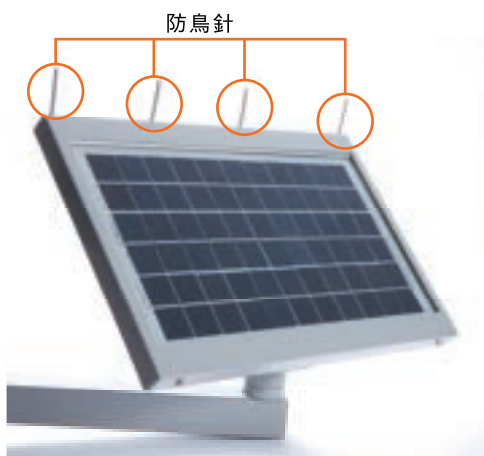
防鳥針がないと鳥が留まり糞がパネルを 覆い機能が低下してしまいます
